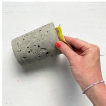
5. Am nächsten Tag die ausgehärteten Formen vorsichtig mit Hilfe des Spachtels aus den Formen lösen. Kanten mit dem Schmirgelpapier glatt schleifen.
