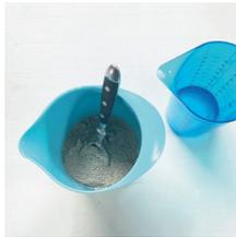
1. 500 g Beton mit 75 ml Wasser in einem Gefäß anmischen. Wichtig ist, dass keine Betonmasse mehr trocken ist.
