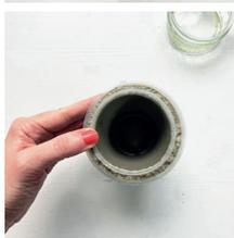
3. Anschließend den kleinen Becher von außen einpinseln und mittig in die gefüllte Form drücken. Die obere Betonkante des Bechers so glatt wie möglich streichen. Gegebenenfalls einen Spachtel zu Hilfe nehmen.
